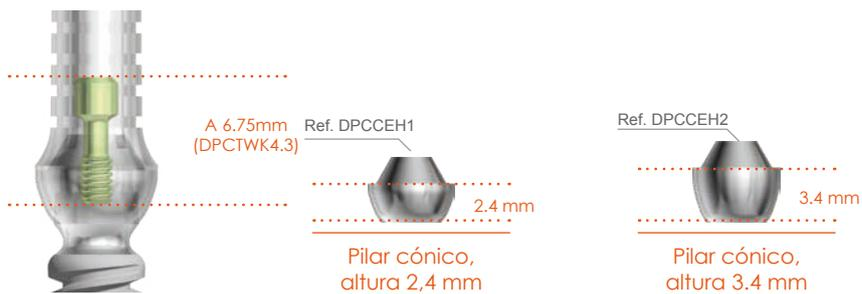
1. El pilar cónico se encaja por fricción en el cono externo y se transatornilla en el implante utilizando el tornillo de fijación protésico. Este ensamblaje aprovecha las características de las conexiones como sobre cono.
