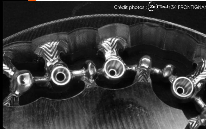
Afin d'assurer la qualité de la connexion prothétique, Global D fournit aux laboratoires de prothèse des pièces telles que les **embases ou les ébauches dont la connectique est usinée par nos soins**. La partie personnalisable sera, quant à elle, travaillée par **les laboratoires de prothèse**.
