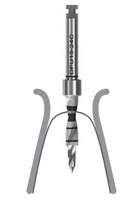
3. Fresa pilota (600-800 tr/min)
